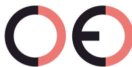
Faux marquage CE (trop éloigné)
