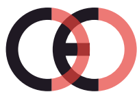
Faux marquage CE (trop proche)
